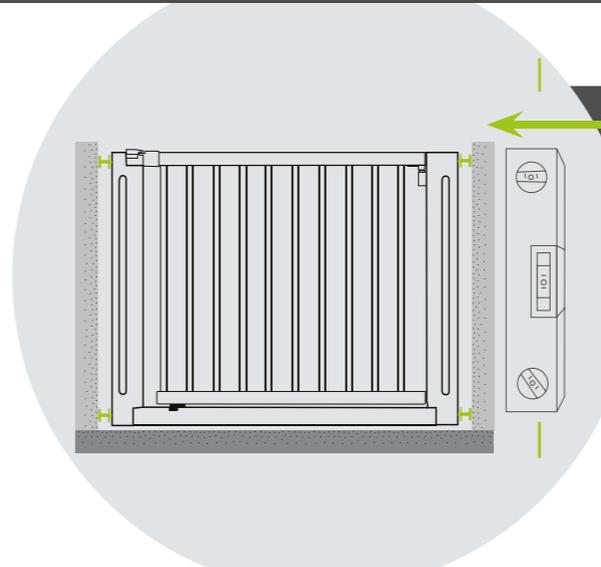
c. Klemmschraube auf der Scharnierseite solange anziehen, bis der Handgriff zum Schloss gerade steht & der silberne Pin unten in den Trichter eintaucht. Mit Wasserwaage ausschließlich senkrecht ausrichten (Nicht oben auf die Tür legen!)
