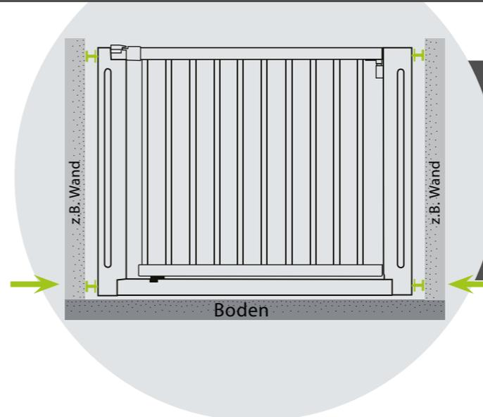
c. Klemmschraube auf der Scharnierseite solange anziehen, bis der Handgriff zum Schloss gerade steht & der silberne Pin unten in den Trichter eintaucht. Mit Wasserwaage ausschließlich senkrecht ausrichten (Nicht oben auf die Tür legen!)
