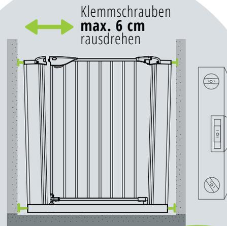
d. Klemmschraube auf der Schlosseite 1-2 Umdrehungen anziehen, bis die Riegel in den Handgriff eintauchen. Nach der Endmontage sollte zwischen Handgriff & Schloss ca. 0,5 cm Platz sein, damit das Öffnen & Schließen einwandfrei funktioniert.
