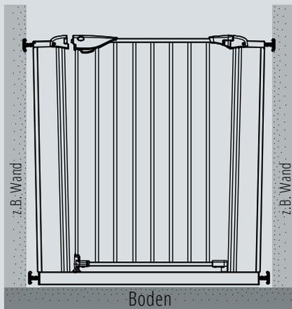
c. Klemmschraube auf der Scharnierseite solange anziehen, bis der Handgriff zum Schloss gerade steht & der silberne Pin unten in den Trichter eintaucht. Mit Wasserwaage ausschließlich senkrecht ausrichten (Nicht oben auf die Tür legen!)
