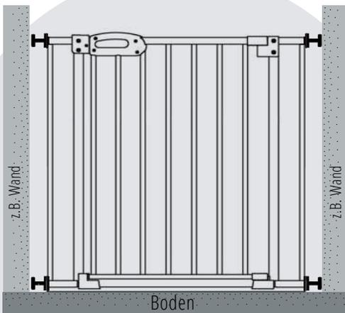
**d.** Klemmschraube auf der Schlossseite 1-2 Umdrehungen anziehen, bis der Riegel in den Handgriff eintaucht. Nach der Endmontage sollte zwischen Handgriff & Schloss ca. 0,5 cm Platz sein, damit das Öffnen & Schließen einwandfrei funktioniert.
