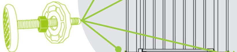
**c.** Klemmschraube auf der Scharnierseite solange anziehen, bis der Handgriff zum Schloss gerade steht & der silberne Pin unten in den Trichter eintaucht. Mit Wasserwaage ausschließlich senkrecht ausrichten (Nicht oben auf die Tür legen!)
