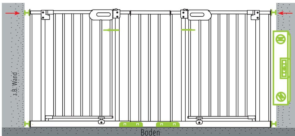
f. Die Klemmschraube auf der Scharnierseite solange anziehen, bis der Handgriff zum Schloss gerade steht & der silberne Pin unten in den Trichter eintaucht. Mit Wasserwaage ausschließlich senkrecht ausrichten (Nicht oben auf die die Tür legen!)
