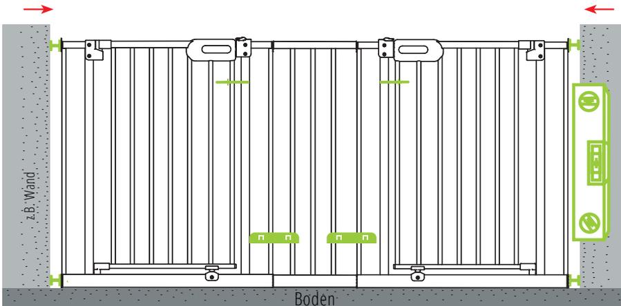
e. Obere Klemmschraube auf der Scharnierseite solange anziehen, bis der Handgriff zum Schloss gerade steht & der silberne Pin unten in den Trichter eintaucht. Mit Wasserwaage ausschließlich senkrecht ausrichten (Nicht oben auf die Tür legen!)
