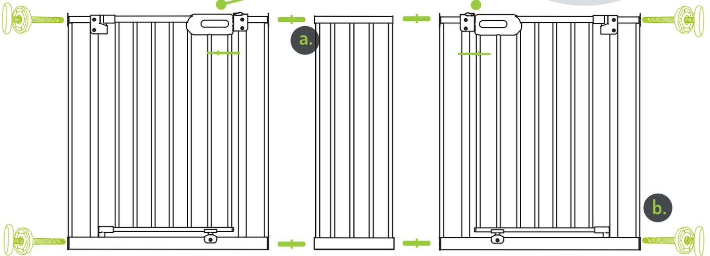
b. Außen in die Türstücke alle 4 Klemmschrauben seitlich in das Gitter stecken. Achtung, kein Gewinde, wird nur gesteckt!
