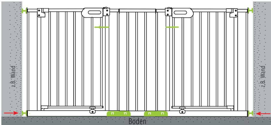
e. Gitter-Konstruktion in den Durchgang stellen.
