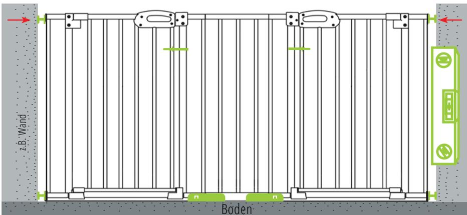
e. Obere Klemmschraube auf der Scharnierseite solange anziehen, bis der Handgriff zum Schloss gerade steht & der silberne Pin unten in den Trichter eintaucht. Mit Wasserwaage ausschließlich senkrecht ausrichten (Nicht oben auf die Tür legen!)
