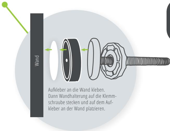
Aufkleber an die Wand kleben. Dann Wandhalterung auf die Klemmschraube stecken und auf dem Aufkleber an der Wand platzieren.
