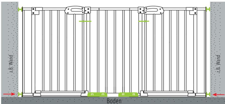
e. Gitter-Konstruktion in den Durchgang stellen.
